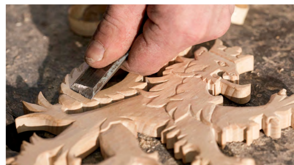
Řemeslné ruční vyřezávání zdobných hlavice žerdi. Používáme především lipové dřevo, a to z českých a moravských lesů.
